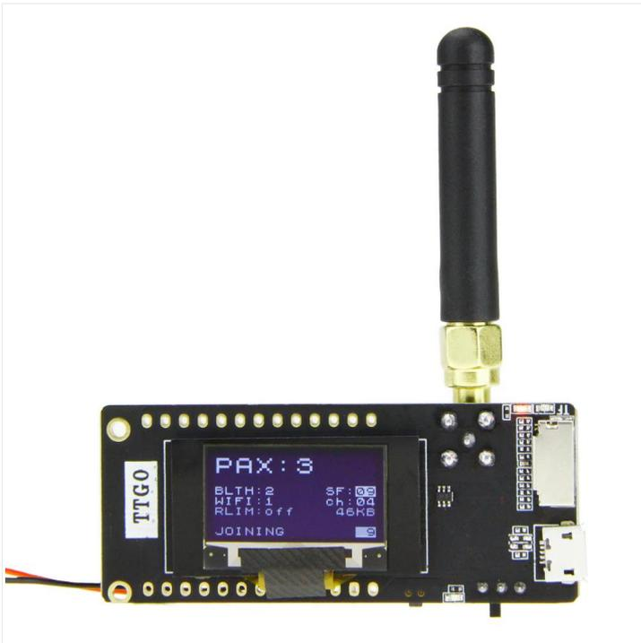
Die Funktion „Wake up“ erfordert (wenn gewünscht!) eine Verbindung von [IO12] nach [Ground] mit einem einfachen Drucktaster.
