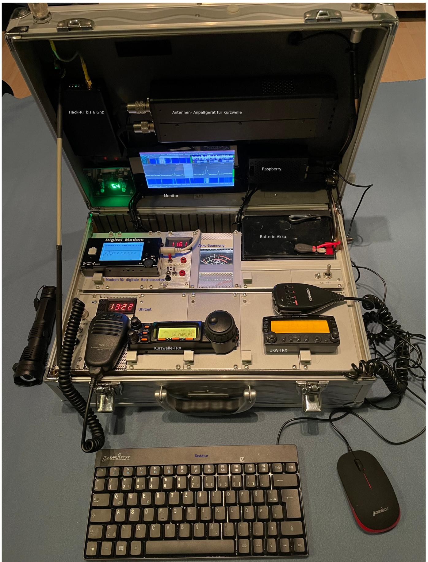
KURZWELLE TRX Yaesu und dazu ein passendes Anpassgerät. Dazu UKW 2m/70cm. Die Antennenanschlüsse für KW&UKW sind nach außen geführt. Ein Empfänger HackRF bis 6 Ghz (mit extra Antenneneingang), ein Display und zur Steuerung ein Raspi. Ein Modem für digitale Betriebsarten. Stromversorgung: Akku und Solarzelle
