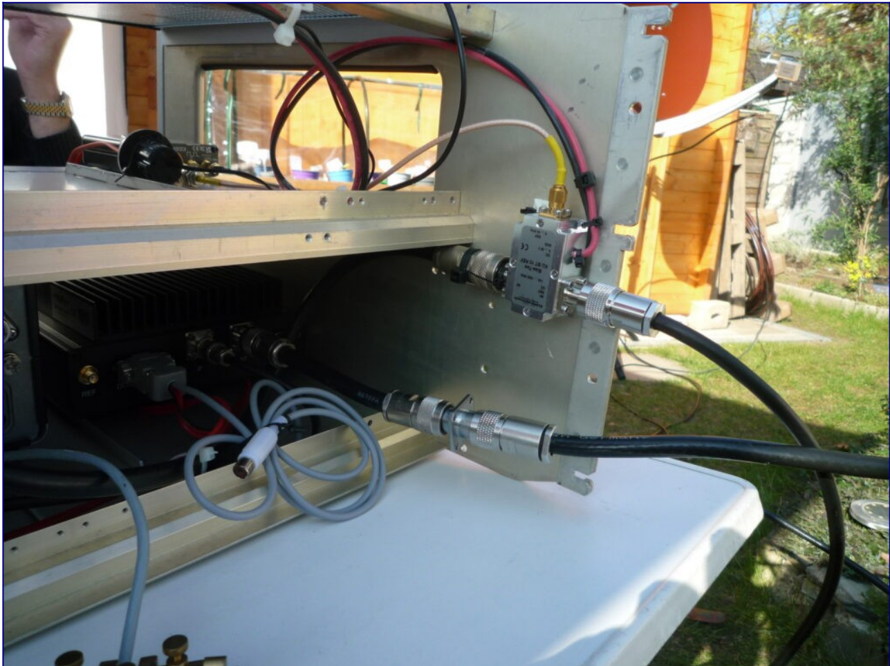
Fernspeiseweiche (oben) und PA-2400MHz Ausgang (unten)
