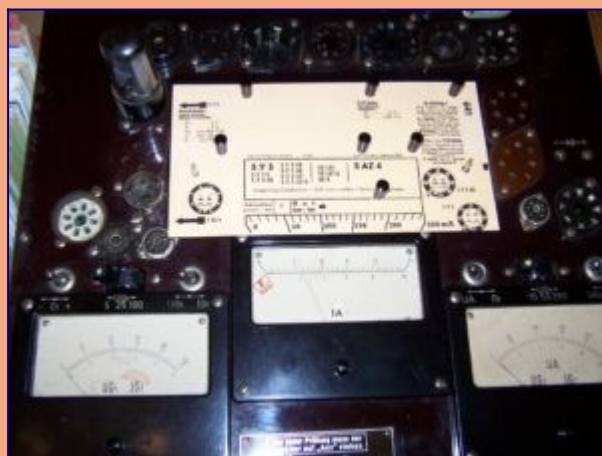
Messung an der Gleichrichteröhre 5Y3. Resultat: Die Röhre ist noch brauchbar.
