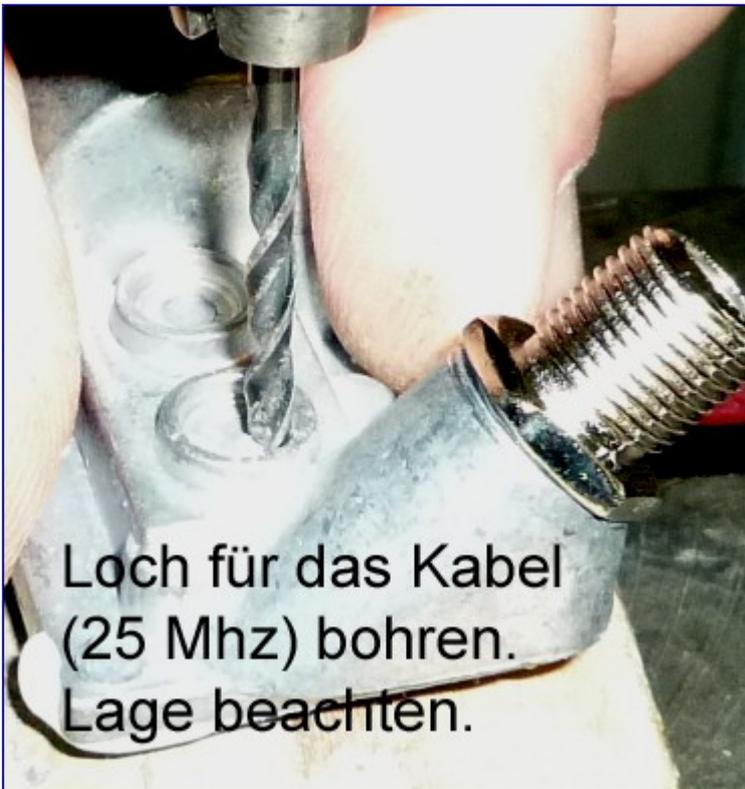
Für die 25MHz-Leitung je nach Kabeldurchmesser bohren (2,6 oder 3 mm). Neben der F-Buchse bohren. Deckel muss auf dem LNB sein damit die Leiterplatte nicht reißt.
