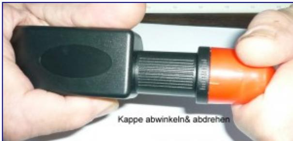
Die Linse/Kappe wird mittels Drehen und Biegen abgenommen
