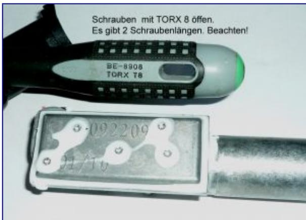
Es gibt 3 kurze Schrauben im Hohlleiterbereich und 2 lange Schrauben hinten an der Buchse. Die Schrauben haben Torx8.
