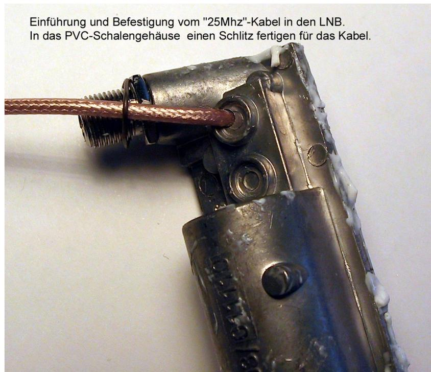
Abdichten vom Kabel mit 2 Komponenten Kleber oder Sekunden Kleber.
