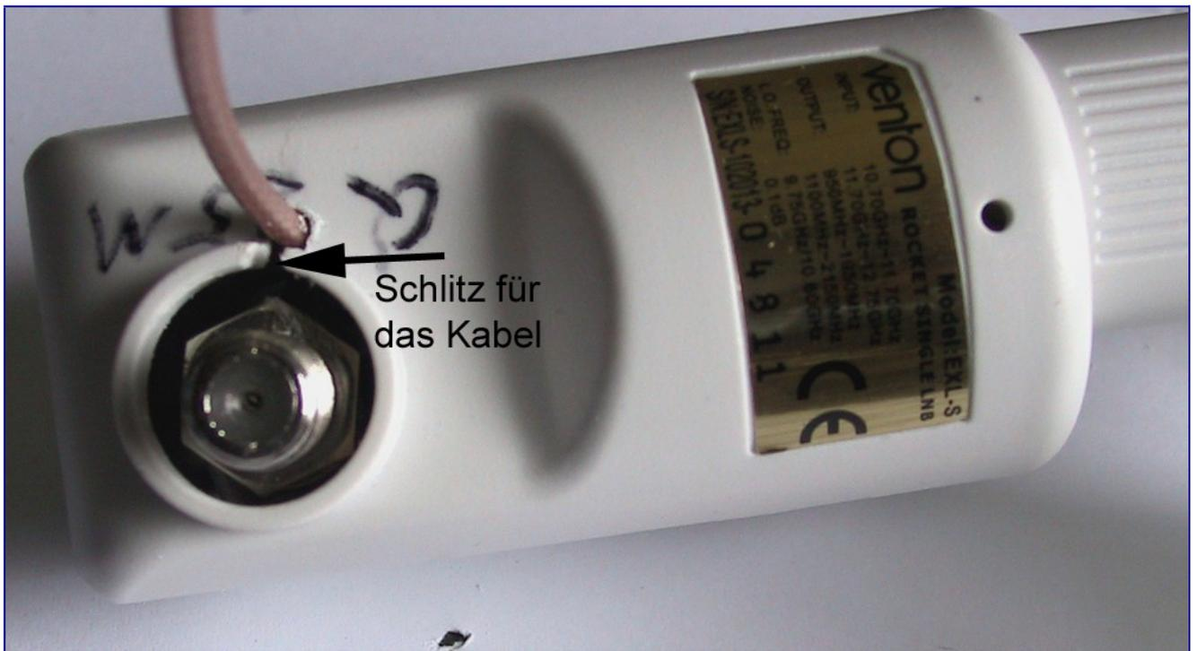
Einen U-Schlitz in das Gehäuse sägen, feilen oder „brennen“ mit dem Lötcolben. Sonst kann das Kunststoffgehäuse wg. dem 25 Mhz Kabel nicht zusammengebaut werden.
