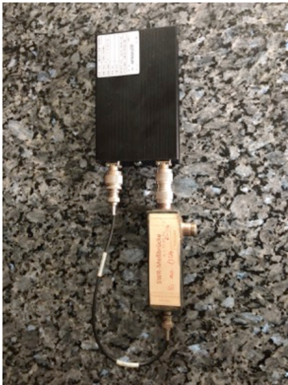
VNA Pro mit Meßbrücke 35 - 4000 MHz
